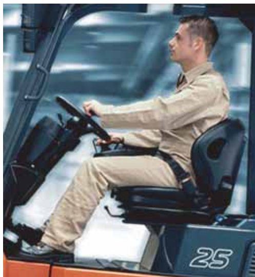
Слика 45 - Седиште конструирано според антропометриски карактеристики на возачот
